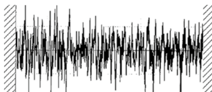
Szlifowanie wykończeniowe powierzchni R_a = 0,223
