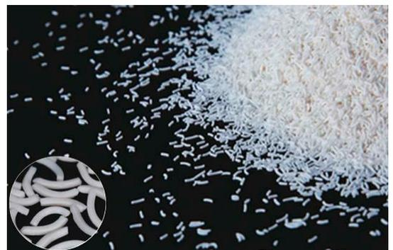
Stäbchenförmiges Sinterkorund für hohe Abtragsleistung
