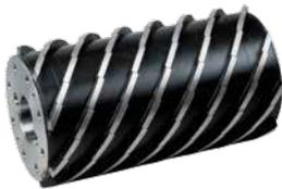
Utensile diamantato con spirali per la calibratura e la rettifica della pietra naturale. La sequenza delle diverse grane del diamante assicura un'elevata capacità d'asportazione e un'eccellente finitura. I rulli sono disponibili in diverse geometrie per ogni dimensione e per tutti i tipi di macchine.
